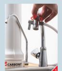
Der Filter wird auf den Kopf gestellt, der Hebel am Umlenkventil in die waagerechte Position gebracht (lenkt Wasser durch den Filter) und der Wasserhahn aufgedreht: Wasser fließt durch den Filter, die Luft im Inneren des Gehäuses wird restlos verdrängt. Mit dem Regler am Ventil kann der Wasserdurchfluss gesteuert werden.
