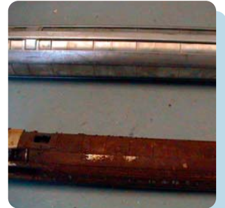
Abbildung G: Brunnenrohr ohne und mit Verockerung
